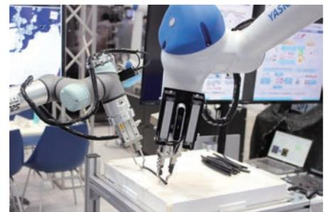
異なるメーカーのロボットを同期させて細長いパッキンを両端から3Dピッキングする（三明機工）
