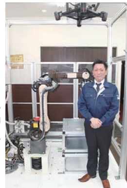
ロボットと3Dビジョンセンサー(上部)を組合せてランダムピッキングを行う装置を紹介するコスモ技研の営業技術部の柴田和宏部長。吸着とクランプのダブルハンド機構搭載。
