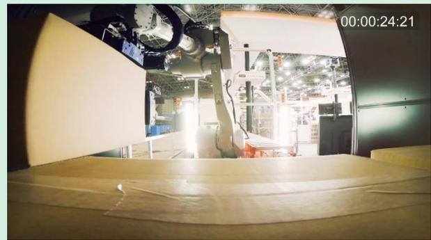
ロボットが自律的にコンテナからばら積みの多品種箱物を取り出す
