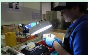
検査員がワークをつかみ、照明の前でワークの向きを変え傷がないか、変色がないか上下左右多方向から目視検査を行っている。
