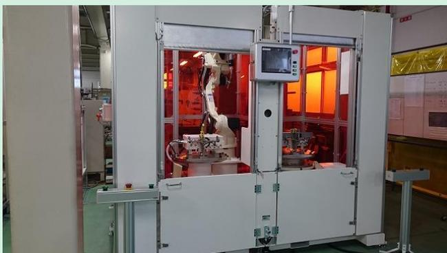
治具にセットされたワークを、溶接トーチを把持した多関節ロボットにてアーク溶接を行うシステム。2ステージのL側は固定架台、R側には2軸ポジショナーを配置し、溶接姿勢を最適化している。溶接光を遮光する為、自動シャッターを配置している。
