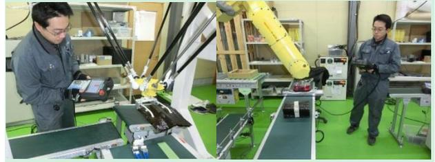
パラレルリンクロボット(M2-ia)と多関節ロボット(M20-ia)の2台で製品に特化したハンドの製作と検証が社内で行うことが出来るので、詳細設計前の構想段階にて海苔や果物などの搬送用のハンドのTRY & ERRORが実現できます。この事により設備開発のリードタイムが短くなり、当社のハンド開発のスキル向上とロボット操作スキル向上が可能になります。
