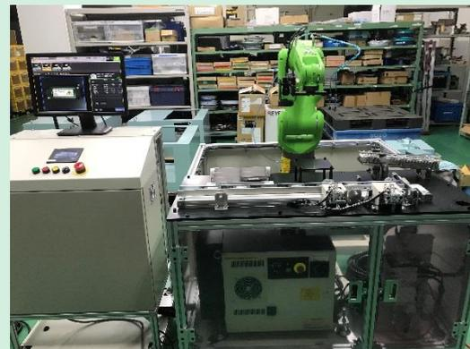
垂直多関節協働ロボットにカメラと照明及び、搬送用吸着ユニットを持たせて、外観検査をロボットに行わせ、ワークの良否判定を行う。
