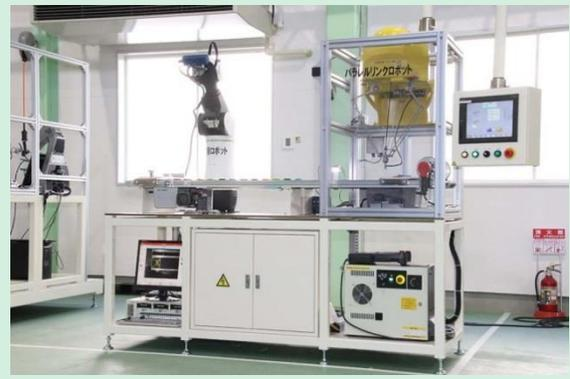
(三次元測定中の多関節ロボットと三次元測定機画面)
