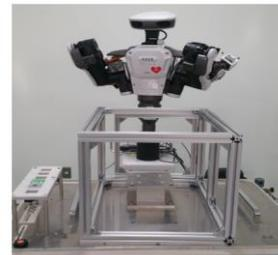
3. ロボット+ 2次元ビジョンセンサ+力覚センサ
