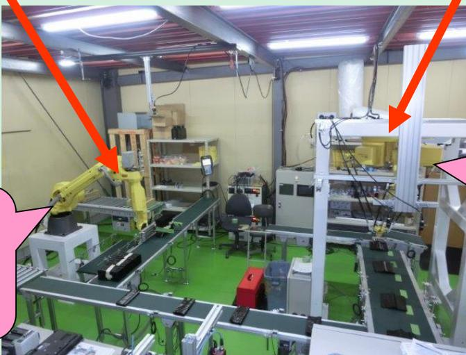
M20のロボットにてダンボールから束上の海苔を方向を識別してコンベア上に乗せます。
