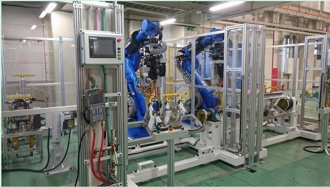
サーボガンを持したロボットにてスポット溶接を行うシステム。ATCを装備し、ワーク形状に合わせ、Xガン／Cガンの持ち替え機能がある。又、溶接姿勢が最適になる様、ポジショナー設置している。
