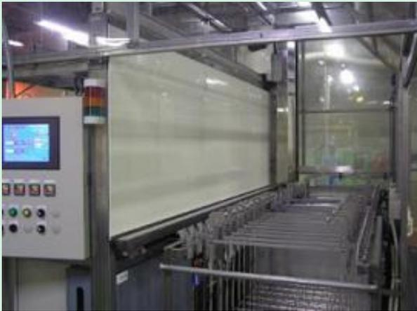
メッキ装置の製造。ワークの装着・脱着の自動化は製造範囲外で、ユーザーに委託(人手作業)していた
