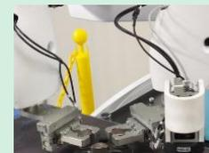
ロボットがワークを指定位置に配置する
