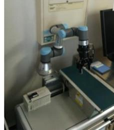
システムインテグレータ育成を目的に、小型のPLCを活用して、コンベアなどの外部機器を制御する体験を行えます。また、ビジョンセンサとの通信方法を学習できます。
