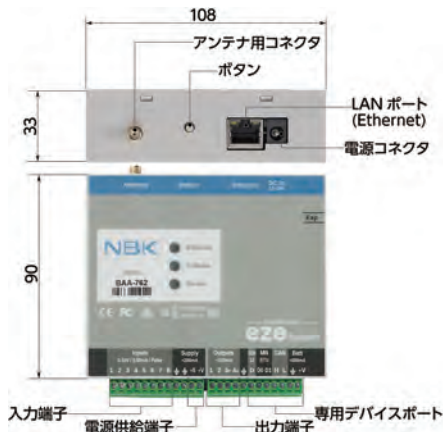
図1: ezeio®の寸法・構造
