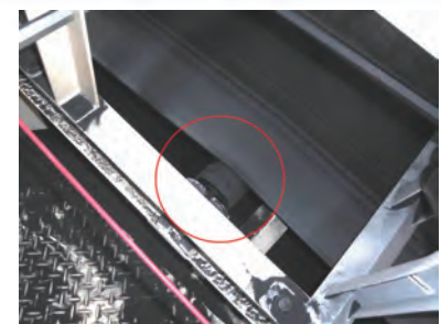
図5: 発見された回転不良のローラ
