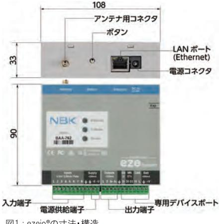
図1 : ezeio®の寸法・構造
