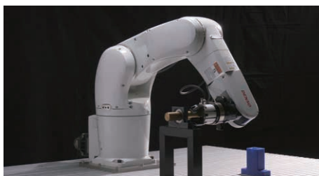
★ 現実とのズレを力覚センサが検出し自動補正
