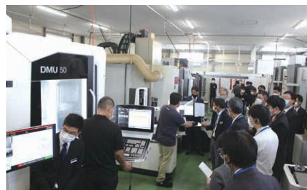
入曽精密は内覧会で5軸加工ナビの指示に従って段取りする様子を披露した。
