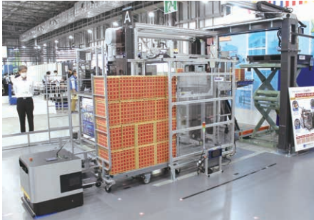
AGVとカート装置を組み合わせた西部電機の自動積み付け・運搬装置（2021年10月に開かれた「国際物流総合展2021 第2回INNOVATION EXPO」から）
