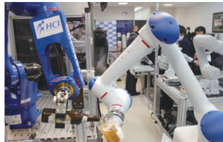
2台の安川電機製ロボットがカメラを使わずにうまく連携する。左の一般産業用が注ぐビールを人協働型が受ける (HCI ROBOT・AI LAB)
