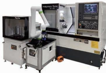
ワーク着脱用協働ロボットシステムを短時間でセットアップできる「Plug One」(中村留精密工業)
