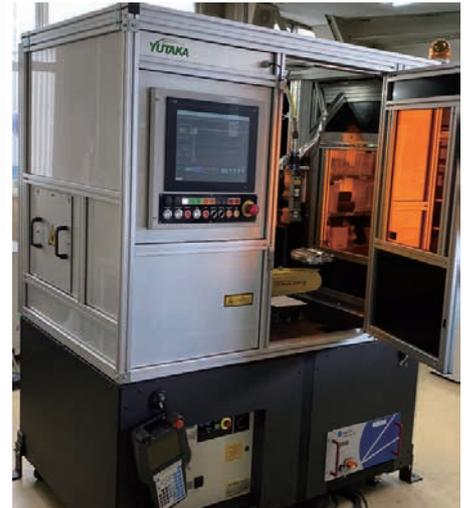
図2 次世代型銅溶接ロボットシステム
