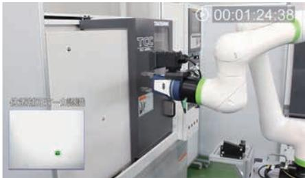
滝澤鉄工所は実演で、ロボットシステムと工作機械との接続、位置認識、設定まで3分28秒で完了させた
