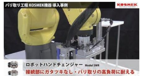
ロボットハンドチェンジャー Model SWR 接続部にカタツキなし・バリ取りの高負荷に耐える
